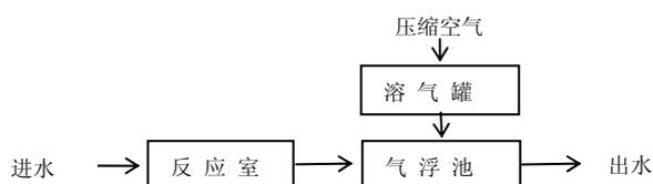
图 4 部分回流溶气气浮基本流程图
